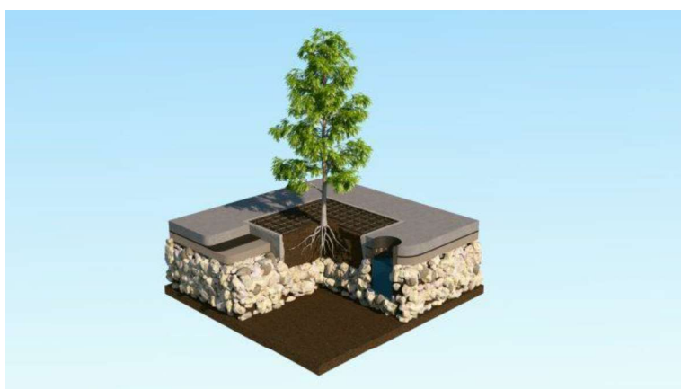
Figuur 21. Voorbeeld van een boomgroeiplaats die kan gebruikt worden om bomen voldoende kansen te bieden in een sterk verharde omgeving. Bron: Blauwgroen Vlaanderen.
