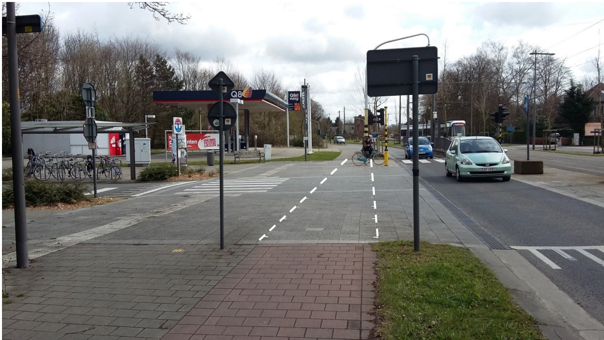
Figuur 22: Liersesteenweg - Hof Savelkoul: voorangsweg: fietspad wordt beter doorgemarkeerd met twee evenwijdige witte onderbroken lijnen (fietspadmarkeringen).
