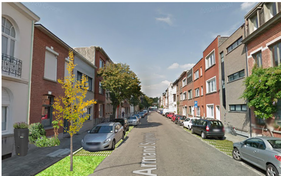
Figuur 17. Voorbeeld van hoe een smalle woonwijkstraat meer water ter plaatse kan houden met een minimum aan maatregelen, zoals ontharding d.m.v. halfverharde parkeerplaatsen, het omvormen van delen van de straat naar een groene berm met bomen en het nemen van maatregelen op privéterrein zoals gevelgroen en een regenton. Hier zou bovendien nog kunnen gekeken worden naar de mogelijkheid om de straat om te vormen naar een enkelrichtingsstraat, waardoor de vrijgekomen ruimte ook kan ingericht worden als groene infiltratieberm.
